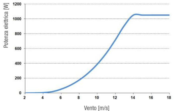
La produzione di energia tiene conto di una probabilità del vento calcolata tramite una distribuzione di Rayleigh, determinata dal valore del vento medio e il fattore di forma di Weibull pari a 2.
